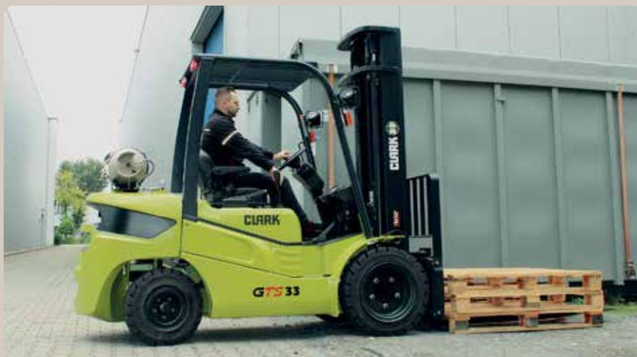
pedali sono disposti in posizione simile a quelli di una automobile, azionabili in modo intuitivo; guida facilitata anche dalla presenza del servosterzo idraulico, che permette di girare in maniera facile e senza sforzo. Integrato in cabina anche un display che consente di avere sott'occhio tutti i dati operativi più importanti del muletto, incluso il livello del filtro antiparticolato adottato nei modelli alimentati a gasolio.
