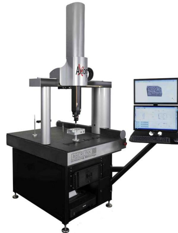
Il tavolo standard in granito e alluminio high-tech, originariamente sviluppato per l'industria ottica, offre un fantastico smorzamento naturale delle vibrazioni ad alta frequenza e la guida a Y in granito consente il precarico dei cuscinetti ad aria del ponte in entrambe le direzioni per una precisione superiore.
