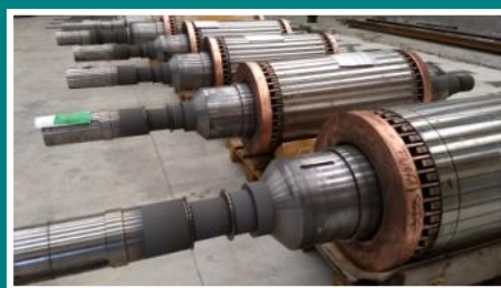
Rotori elettrici rivestiti sulle sedi cuscinetti e zone di usura
