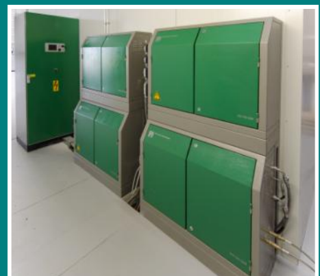
HVOF and Plasma FST MP 50 Multi-Process System
