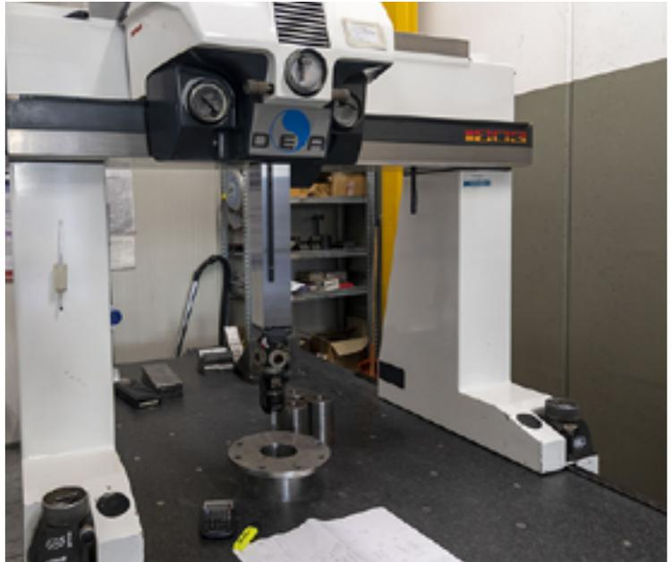
Macchina di misura DEA: tridimensionale, dimensioni misurabili asse X = 1.450 Y = 1.000 Z = 900. Precisione strumento 10<sup>-7</sup> m (10<sup>-4</sup> mm).
