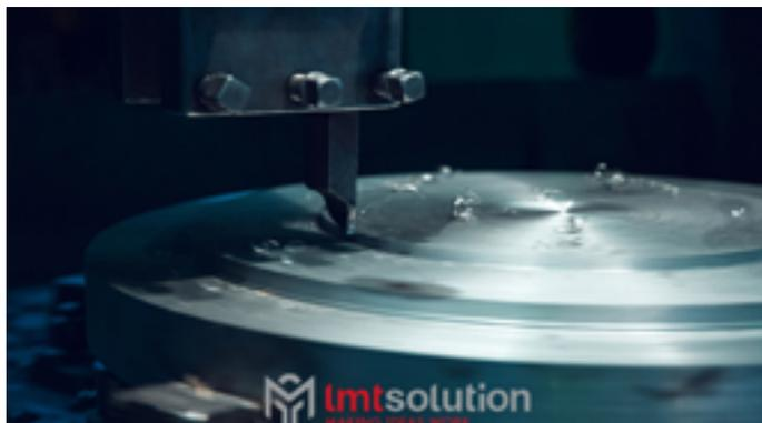
Tornitura CNC orizzontale e verticale a 2,3 e 5 assi, max 2000 tornibile, lunghezza max 3,200 mm.
